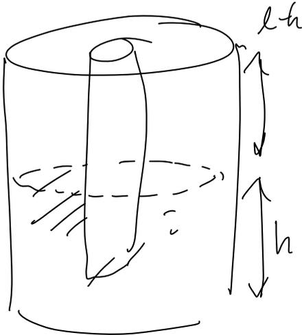
Cuando el dieléctrico está a altura  $h$ , se puede considerar como un sistema de dos condensadores en paralelo, con capacitancias:
