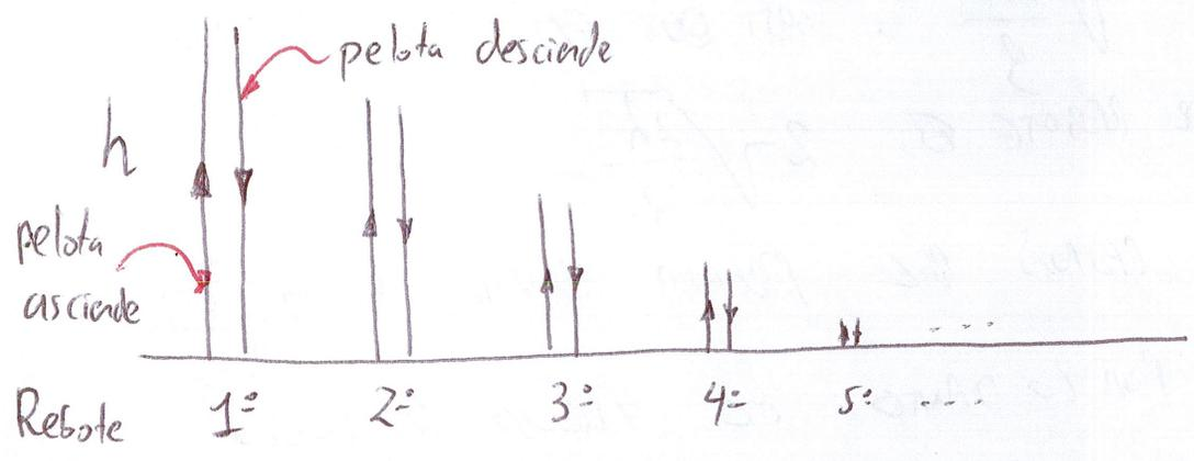
1.a) En el primer rebote la pelota sube y baja recorriendo una distancia  $2h$ . Después del primer rebote la pelota recorre una distancia  $2hf$ . Entre los sucesivos rebotes, la pelota recorre una distancia  $2hf^2$ ,  $2hf^3$ , ..., y así sucesivamente. La distancia total es la suma de estas distancias:
