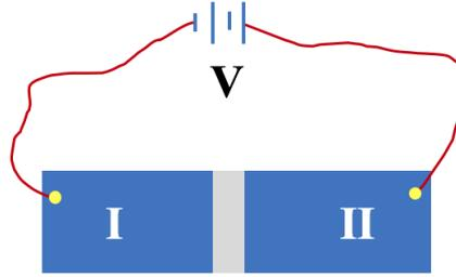
**Pregunta 4** Considere dos metales superconductores I y II separados por una capa delgada de un material aislante, tal que la función de onda de un electrón puede estar definida entre los dos metales. Esto se conoce como una Juntura Josephson. Una fuente de voltaje  $V$  es conectada a través de la juntura para asegurar que en promedio existe neutralidad de carga. Esta situación puede ser descrita por medio de las siguientes ecuaciones de Schrödinger
