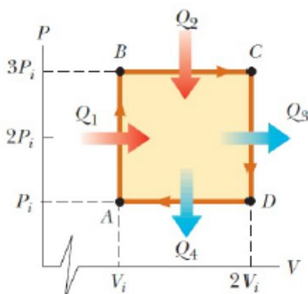
Figura 1: Una sencillísima máquina térmica. Todos los cálculos deben hacerse algebraicamente!!
