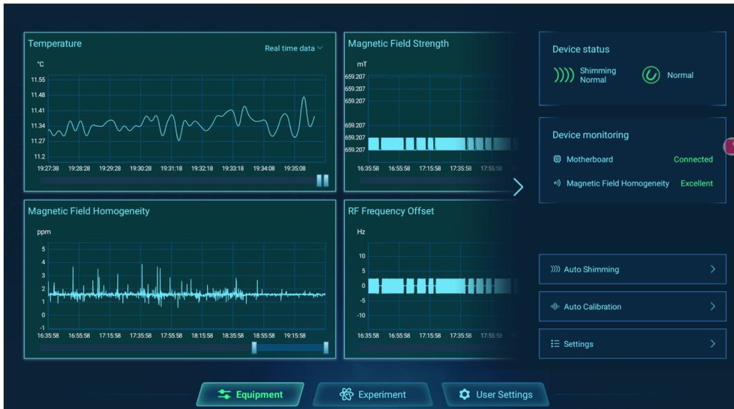
Figura 6: Imagen de la interfaz de monitoreo de las condiciones del computador. En esta imagen se muestra el estado del computador en la parte derecha. Las gráficas mostradas corresponden a la temperatura del computador, y la homogeneidad del campo magnético producido por los imanes de neodimio.
