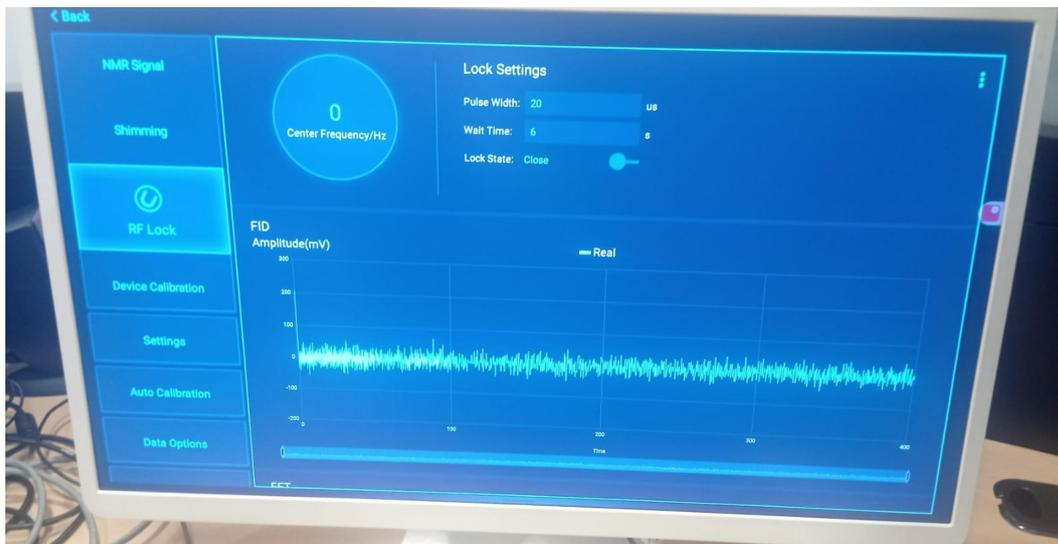
Figura 3: Foto de la pantalla táctil mediante la cual se controla el computador cuántico.
